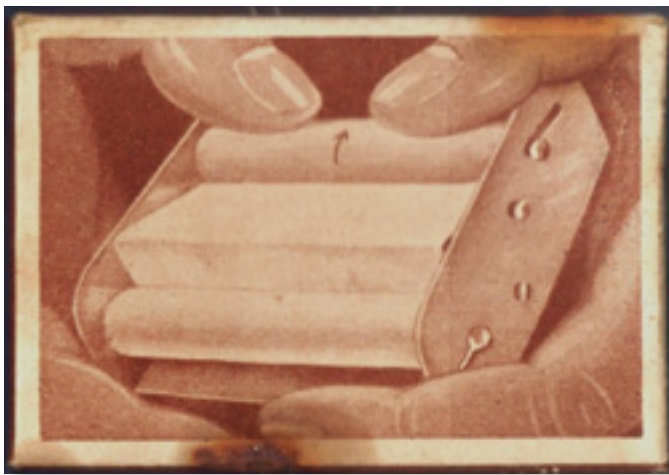
Savukkeenkäärijä eli sätkäkone. Rasian takakannessa ovat käyttöohjeet. Yksinvalmistaja Jalmari Ahokas Helsinki.
